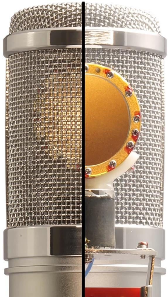
ELA M 251 于 1960 年至 1965 年由 AKG 为 Telefunken GmbH 生产，至今仍是稀有和令人垂涎的老式话筒之。虽然 251 与 C 12 的演变相差不大，但仍有些关键差异。它们都采用双面 34mm 双背板、边缘端接镀金聚酯薄膜胶囊和 6072A 电子管。它们都采用 T/14 输出变压器。电路的不同之处在于管栅和阴的处理方式。这使 22 251 的增益比 P-12 多 7 dB。此外，251 的头罩比 12 大点，改变了频率响应。无论您选择 Peluso 22 251 还是 P-12，您都将拥有支具有这些经典传奇的清晰度、开放性和高“空气感”的话筒！
