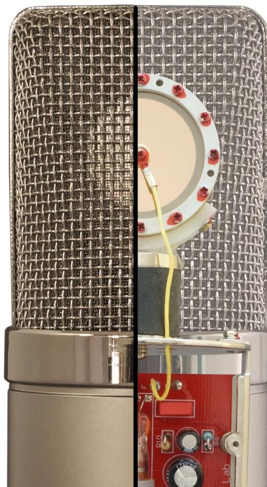
M 49 于 1949 年至 1974 年生产，是款能够远程模式控制的电容话筒，当然我们的 P-49 有个远程控制 9 种模式更换。头部格栅与胶囊的独特倾斜关系减少了格栅共振。微型三管的设计特别适合麦克风使用，具有长寿命、低电流消耗和高输入阻抗。尽管开发合适的输出变压器成本高且复杂，但这是实现复古 '49 音质的后关键步骤。P-49 是款出色的人声话筒。P-49 具有中频细节和独特的高频平滑度，可为人声、小提琴或鼓带来饱和的温暖感。
