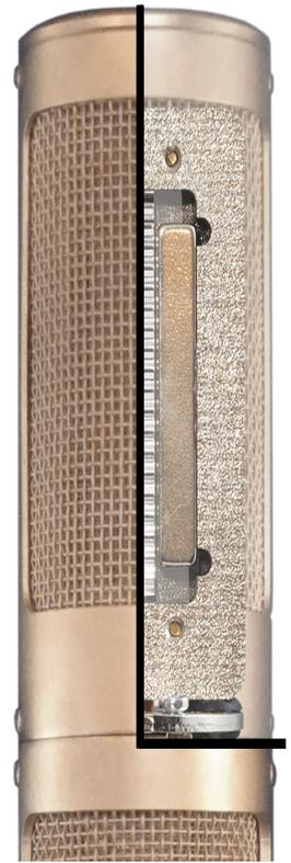
我们采用了经典的长铝带结构。薄的波纹铝带在两块稀土钕磁铁之间被拉紧。当铝带随着周围声学空气压力的变化而移动时，铝带就会产生电流，这个电流就是传声器的输出信号。铝带被放置在磁铁中心的正前方。这在传声器的背面提供了个非常轻微的低端衰减，如果需要对抗邻近效应，这将是非常有用的。
